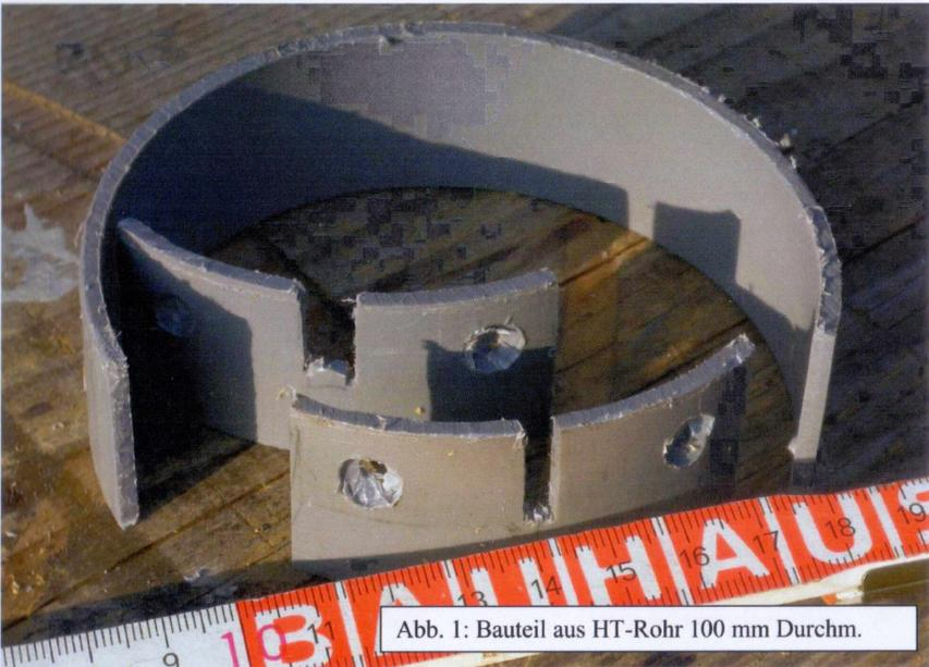
Abb. 1: Bauteil aus HT-Rohr 100 mm Durchm.
